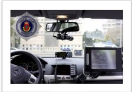
La función principal del Multacar es la de denunciar los malos estacionamientos y localizar a los vehículos robados o buscados por los cuerpos y fuerzas de seguridad. Es un vehículo fácil de identificar puesto que cuenta con una cámara, incorporada en el techo, que será la encargada de visualizar y fotografiar las infracciones. Estas imágenes guardan la hora y el lugar en el que se ha cometido la infracción.
