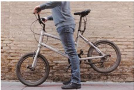
**B: Brakes (funcionamiento de los frenos)** Asegúrate de que tus frenos funcionan bien. Gira ambas ruedas hacia adelante (una detrás de otra) no deberían detenerse en, al menos, 10 segundos. Las manetas de freno no deberían tocar el manillar cuando las pulsas (debería caber al menos un dedo entre
